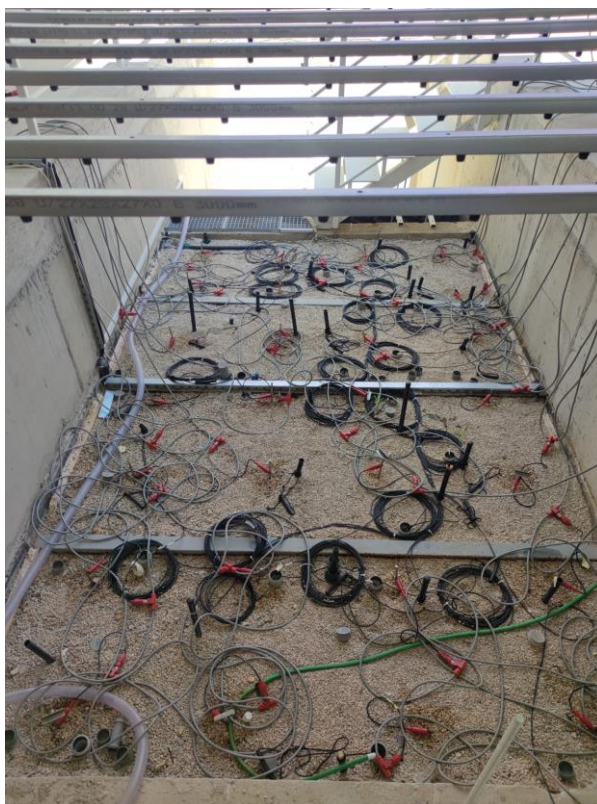
Slika 13 Geoelektrično mjerenje na testnom poligonu u sklopu Hydrolaba u Žrnovnici.
