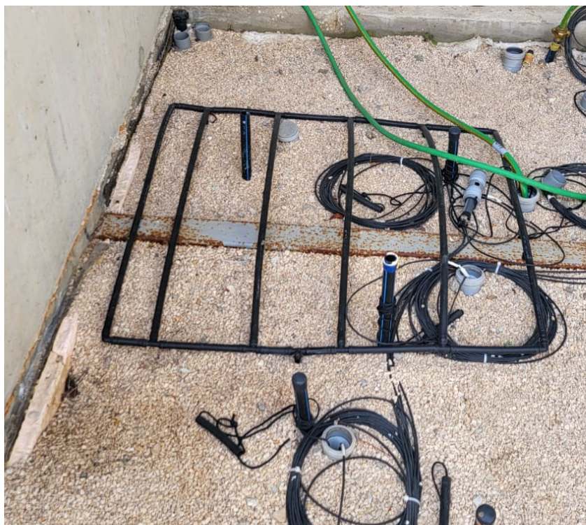
Slika 30: Površinsko utiskivanje trasera preko sistema prskalica.
