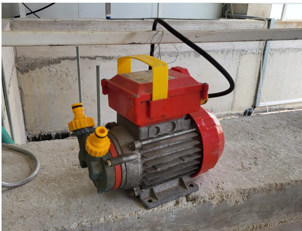
Slika 28: Pumpa za injektiranje slanog trasera iz spremnika u matricu.
