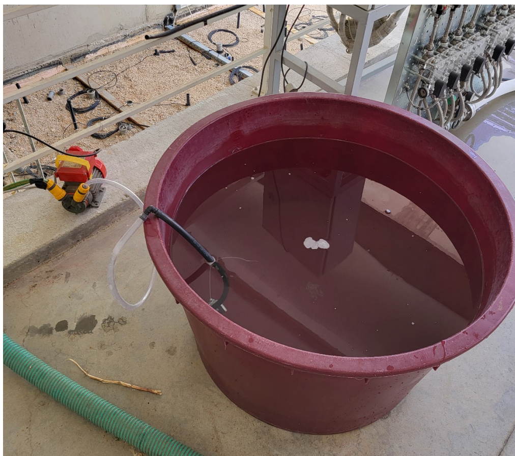
Slika 26: Spremnik za vodu (badanj) iz kojega smo utiskivali slani traser u matricu.
